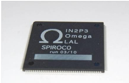
TQFP: height=1.4 mm
